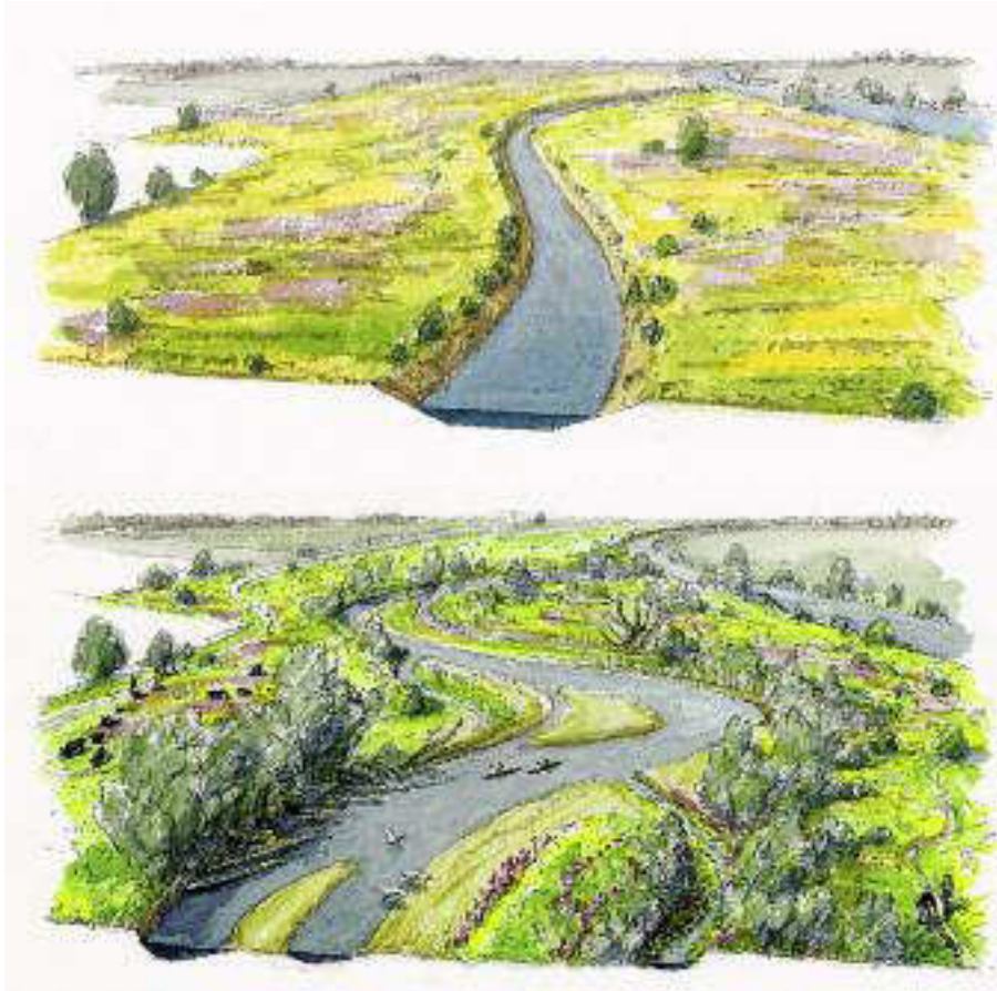
Impressie van de ontwikkeling van de toekomstige nevengeul bij Afferden. De geul wordt strak aangelegd (plaatje boven), waarna vervolgens de natuur door erosie het werk doet. Het plaatje onder geeft een impressie van het uiteindelijke resultaat. Het is echter niet precies te voorspellen hoe de geul eruit gaat zien.
